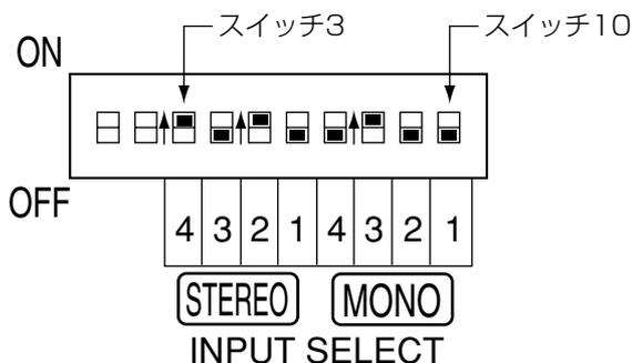
例) 上図はステレオ入力4（STEREO INPUT 4） とステレオ入力2（STEREO INPUT 2）、モノラル入力3（MONO INPUT 3）をサブ出力にアサインする例です。
