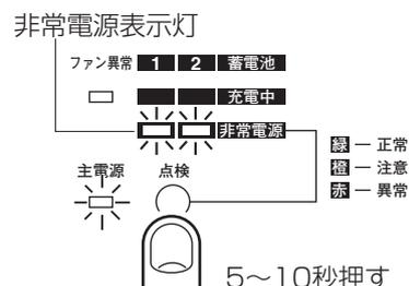
正しく点検するために、点検スイッチは5秒以上押ししてください。ただし、点検中は蓄電池を消耗しますので、10秒以内に放してください。
