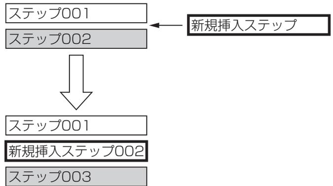
**1** 挿入する位置の直後のステップを表示させ、を押します。
