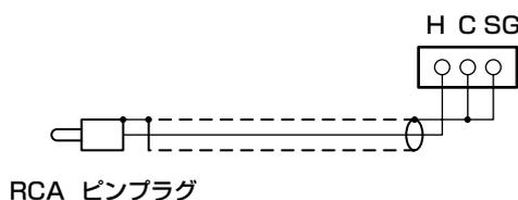
※ピンプラグからのシールド線とSGを接続し、C (コールド) とSG (シグナルグランド) を接続します。
