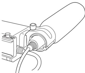
**3** マイクの接続ケーブルをカメラの MIC IN 端子に接続します。
