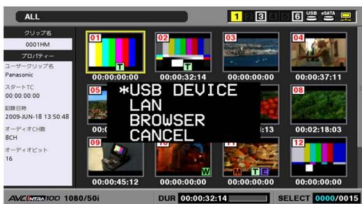
液晶モニターのUSB DEVICEの文字が点滅してモードが切り替わります。モードが切り替わると、液晶モニターにUSB DEVICE DISCONNECTと表示されます。その後パーソナルコンピュータとの接続が完了すると、USB DEVICE CONNECTの表示に切り替わります。
