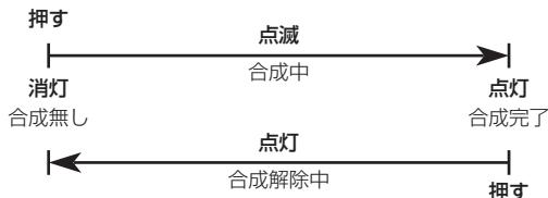
ボタンを長押ししたあと、押した状態のままで OSD/TIME ダイヤル (⑦) を回すと、トランジションタイムを変更することができます。
