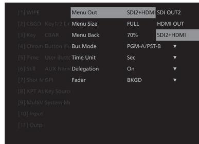
[12] Config の Operate > Menu Out 項目の設定で、OSD メニューの出力端子が変更できます。
