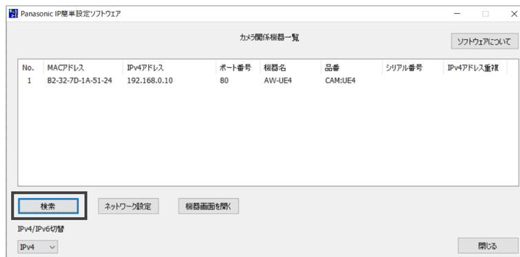
3 カメラの MAC アドレス/IPv4 アドレスをクリックし、続いて [ネットワーク設定] ボタンをクリックします。
