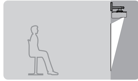
壁掛け設置で後方から投写する場合 (透過式スクリーン使用)
