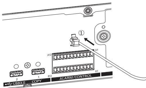
①ケーブルクランプ（付属品）をケーブルクランプ取り付け穴に差し込みます。
