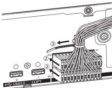
②端子台プラグをアラーム／コントロール端子AおよびBに挿入します。
