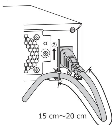
②電源コードのコネクタから15 cm ~ 20 cmのところを締めてクランプマウントに固定します。電源コードクランプのあまた部分は必要に応じて切断してください。
