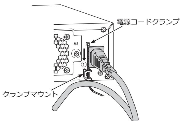
①クランプマウントに電源コードクランプ（付属品）を通します。
