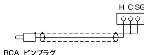
※ピンプラグからのシールド線とSGを接続し、C (コールド) とSG (シグナルグラウンド) を接続します。
