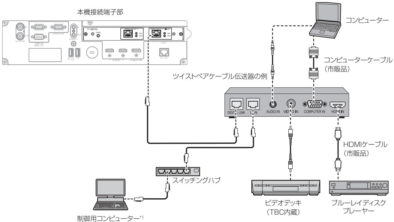
\*1 制御対象は本機、またはツイストペアケーブル伝送器になります。ツイストペアケーブル伝送器によっては制御そのものができない場合がありますので、接続する機器の取扱説明書をご確認ください。
