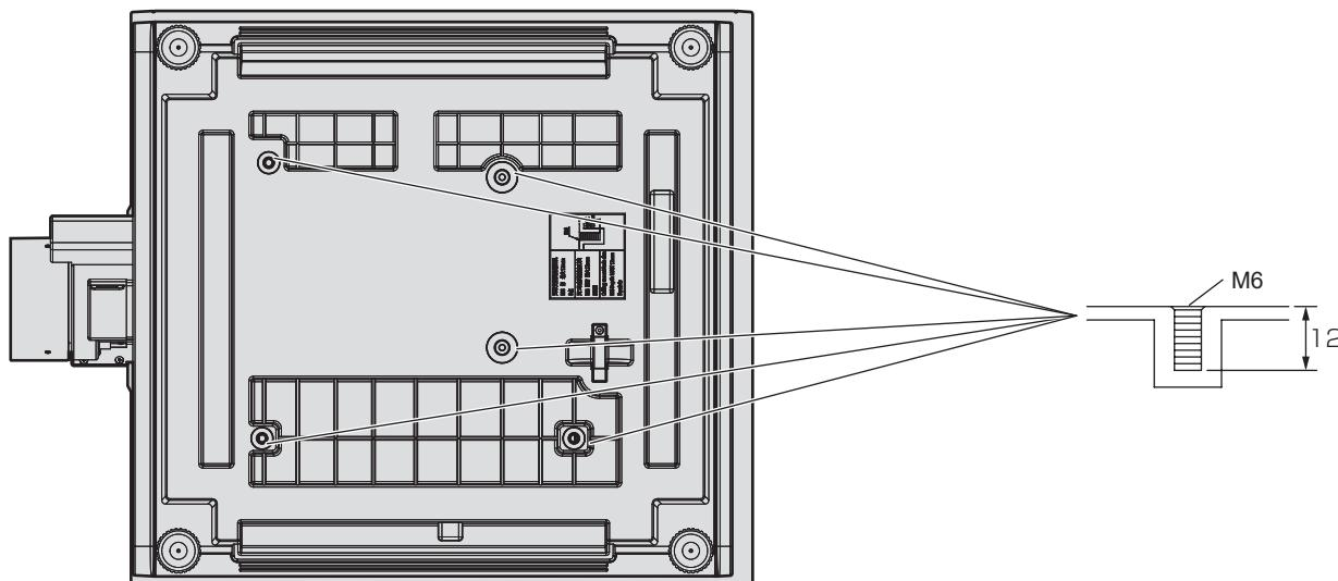
■ プロジェクター固定用ねじ穴寸法図（本体底面）
