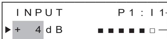
設定中のバランス入力端子の番号と、設定中のバランス入力端子がパッチされているインプット／バス／マトリクスを表示しています。
