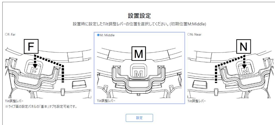
カメラを設置したときに設定した[TILT調整レバーの位置]を選択します。
