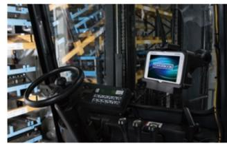
**車載取付時のご注意(共通)** タブパッド本体は、耐振動設計となっておりますが、車両への取付状態によっては、共振などにより振動が増大し故障を誘発する可能性があります。また、ご利用の際には、マウンターと外付けアンテナは極力離してご利用ください。車両に常時搭載された場合における不具合は保証の対象外となりますので、設置・取り付け方法・保証に関しては、ホームページの「車載運用支援ソリューション」をご参照ください。
