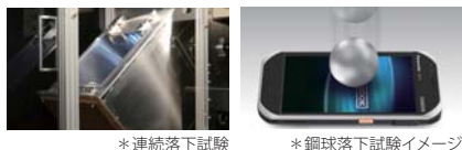
*連続落下試験 *鋼球落下試験イメージ
