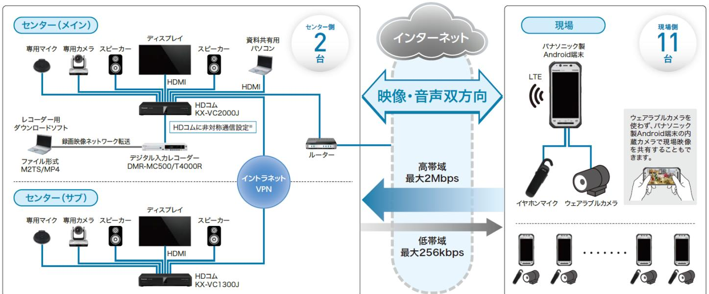
※HDコム本体に非対象通信を設定した場合、HDコムLiveに加えて、HDコムモバイル（Android）も非対称通信で動作します。
