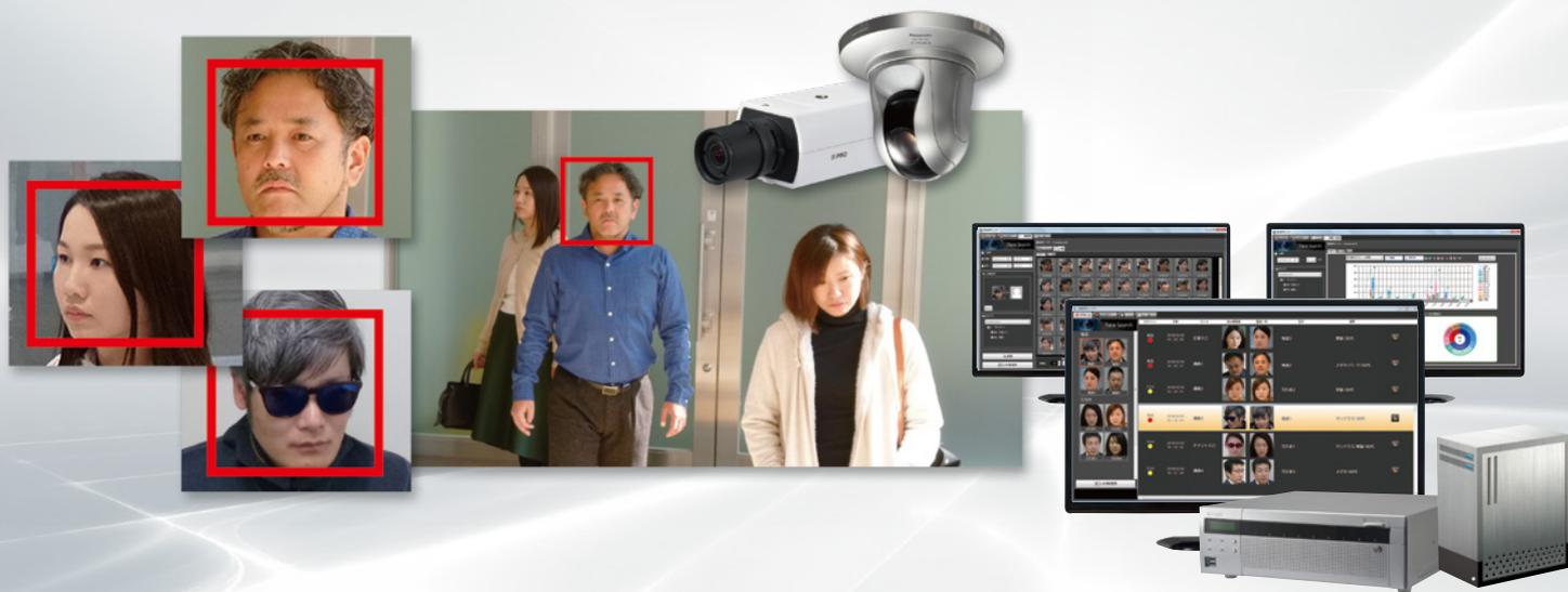
ディープラーニング顔認証システム『FacePRO』は当社製の指定ネットワークカメラと、サーバーにインストールした顔認証ソフトウェアによって実現する、監視システム用途の顔認証システムです。WV-ASF950をインストールしたコンピューター（以降、本機と略します）は当社製の指定ネットワークカメラにて撮影された人物の顔画像を受信し、顔画像および、顔の特徴情報をデータベースに蓄積します。
