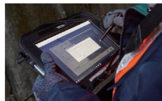
トンネル点検業務でFZ-G1とインフラ点検レポートサービスを使用。従来、変状の記録に使用していたA3サイズの野帳と比べコンパクトで機動性があり、タッチペンでの記入もスムーズと好評。
