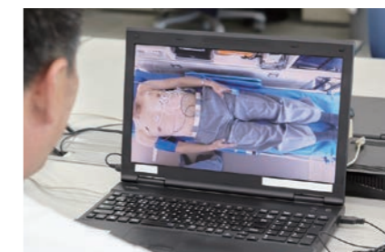
救急車の天井に設置した車載カメラからの映像をPCで受信。FZ-M1の画像処理能力により、クリアな映像が確認できる。
