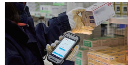
低温倉庫内の格納処理で、斜め配置バーコードリーダー搭載のため使いやすいといわれるFZ-N1
