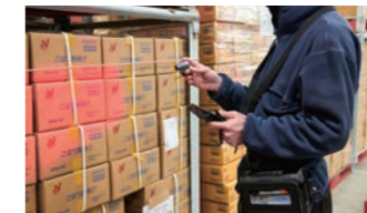
▲現場スタッフが首からタフパッドを掛け、指にスキャナ、腰にプリンタを装着して入荷検品作業をします。
