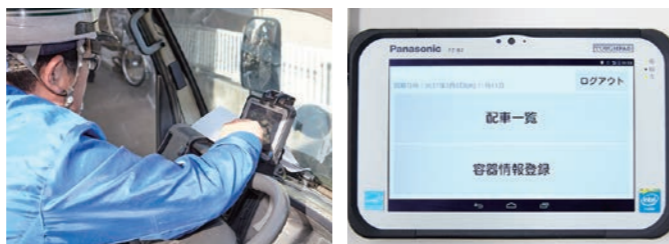
(写真上) FZ-B2で電子マニフェストを入力した後、お客様に確認。高輝度の液晶で屋外でも見やすく。(写真左) 運転席にFZ-B2を取り付け、カーナビとして使用。専用カーナビより便利と好評。(写真右) 自社開発アプリ起動画面。ボタンが大きく、ベテラン乗務員も直感的な操作が可能。
