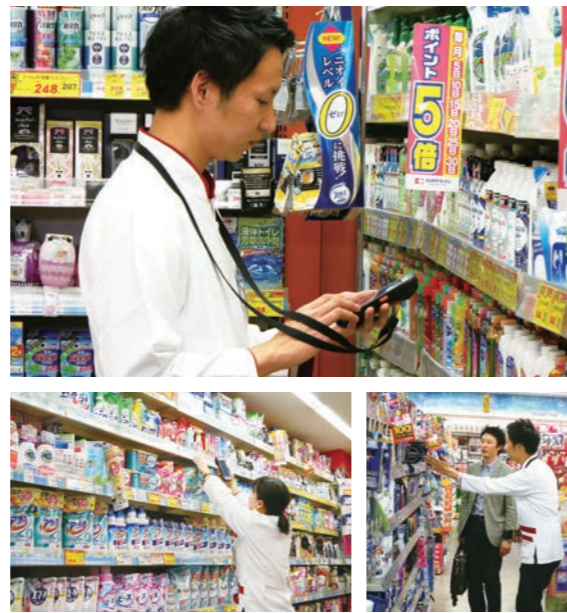
バーコードリーダーで商品バーコードをスキャン。FZ-N1の画面上で、商品在庫の確認や発注、返品などの業務が完了できる。斜め配置のバーコードリーダーで、高い位置でも作業しやすい。 業務の効率化により、従業員が店頭で接客できる時間が増加。商品のご案内など、力を入れた接客サービスが充実。
