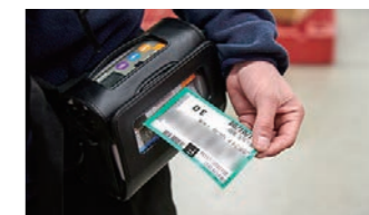
▲全ての入力を終え「OK」ボタンを押すと、腰に装着したプリンタから入庫タグが出力されます。
