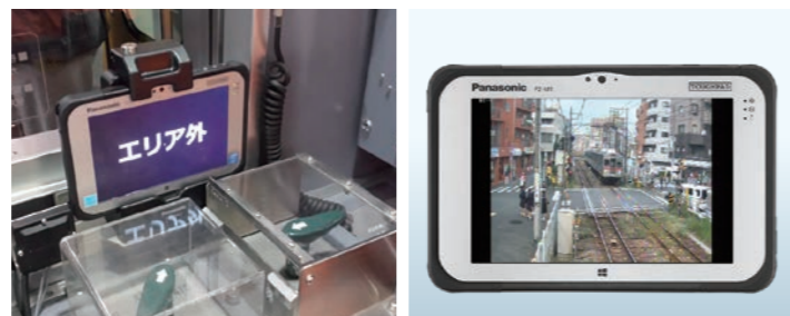
運転台後方に取り付けたTOUGHBOOKの様子。踏切で異常が発生した際、踏切監視カメラの映像をTOUGHBOOKで受信(画像は実際の踏切監視カメラの映像です)。通常運行時は「エリア外」表示。
