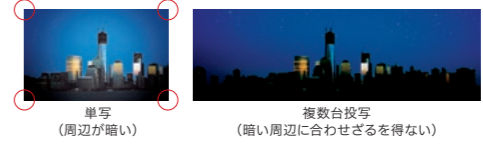
平均照度: 5% 平均照度: 15% 全体平均照度: 10% 全プロジェクター映像の平均照度に基づいてダイナミックコントラストを設定し、エッジ部分もスムーズに表示 シャッター連動: オフ プロジェクターA プロジェクターB シャッター連動: オン マスタープロジェクター スレーブプロジェクター マスタープロジェクターでシャッター機能を実行すれば、スレーブプロジェクターも連動* *フェードイン/アウトのエフェクトも含まれます。スレーブ個々での実行も可能です。
