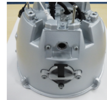
耐重塩害仕様のカメラ：腐食なし
