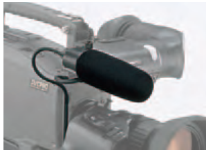
マイクロホンキット(モノラル) AJ-MC700P(XLR3 pin) 本体希望小売価格 85,000 円(税抜) ビューファインダーに取り付けられます (マイクホルダー付)。 ●消費電力：ファントム電源 11 V-49 V ●消費電流：2.4 mA ●質量：約104 g ●外形寸法：直径21 mm×全長139 mm
