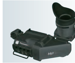
3.45型カラーHDビューファインダー AG-CVF15G 本体希望小売価格 350,000 円(税抜) 3.45 型約92 万画素 16:9カラー-LCDを搭載。 アイピース開閉部 2か所。 ●消費電力：5.7 W ●質量：約650 g ●外形寸法：幅249 mm×高さ78 mm×奥行227mm
