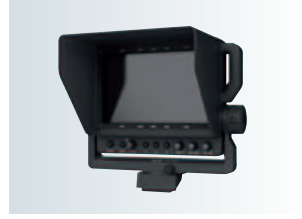
7型カラー液晶ビューファインダー AK-HVF75GJ 本体希望小売価格 700,000 円(税抜) 新LCDパネルを採用。 ●電源：DC 12 V(カメラより供給) ●消費電力：11 W ●外形寸法：幅 243.5 mm×高さ 212 mm×奥行 172 mm(フード含む)、幅 243.5 mm×高さ 212 mm×奥行 85 mm(フード含まず) ●質量：約 1.6 kg(フード含まず)
