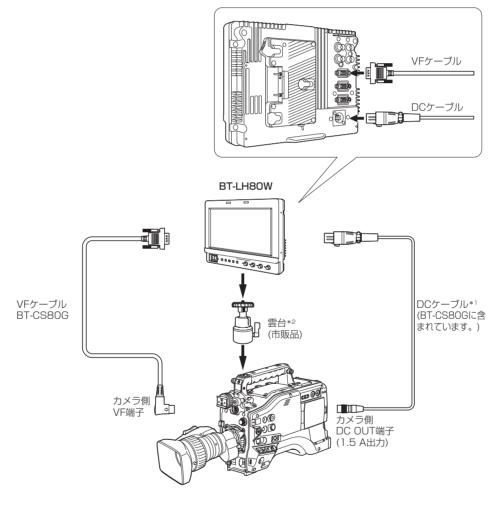
\*1 DC電源供給(出力電流1.5 A)可能な放送業務用カメラレコーダー
