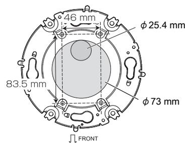
※図中のグレーの部分は配線用の穴です。設置時にカメラの取付方向が決まっている場合はφ25.4 mm、決まっていない場合はφ73 mmの穴をあけてください。
