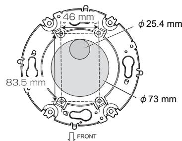
※図中のグレーの部分は配線用の穴です。設置時にカメラの取付方向が決まっている場合は  $\phi 25.4$  mm、決まっていない場合は  $\phi 73$  mm の穴をあけてください。
