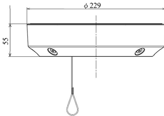
●接続管用めねじは、JIS C 8305 (電線管ねじ) の CTG22 またはJIS B 0202 (管用平行ねじ) の G3/4に対応しています。
