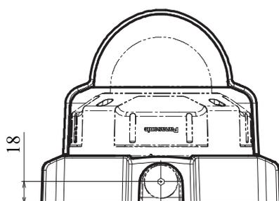
●天井や壁面の状態によって次の6通りのねじ位置で固定できます。(使用ねじ:M4)
