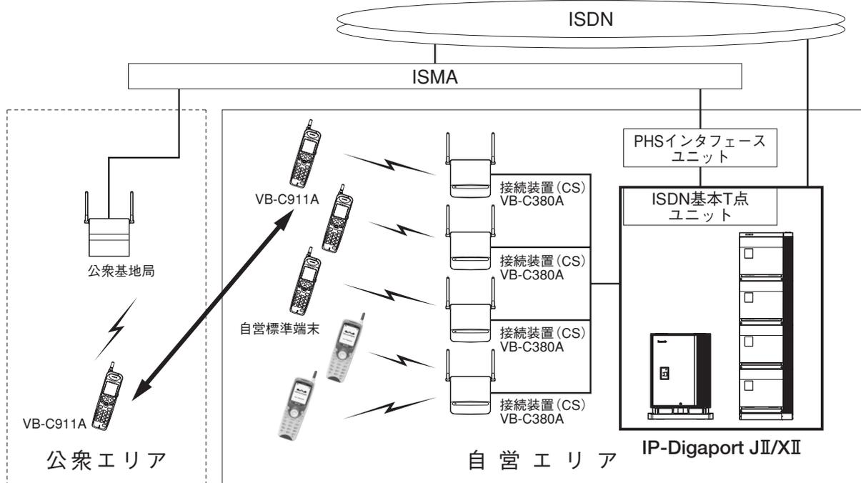
※ 大型機種用 CPU ユニット (CPC-L) VB-D977A / 大型機種用高級 CPU ユニット (CPC-LL) VB-D978、タイムスイッチユニット (TSW) VB-D779、OS 対応運用メモリー (VB-D9770J / VB-D9780JA)、または、OS 対応標準 CPU ユニット (CPC-SJ) VB-D678JA および デジタルシステムコードレス用網同期パッケージ (ESCK) VB-D780J、ISDN 基本 T 点ユニット等が必要です。
