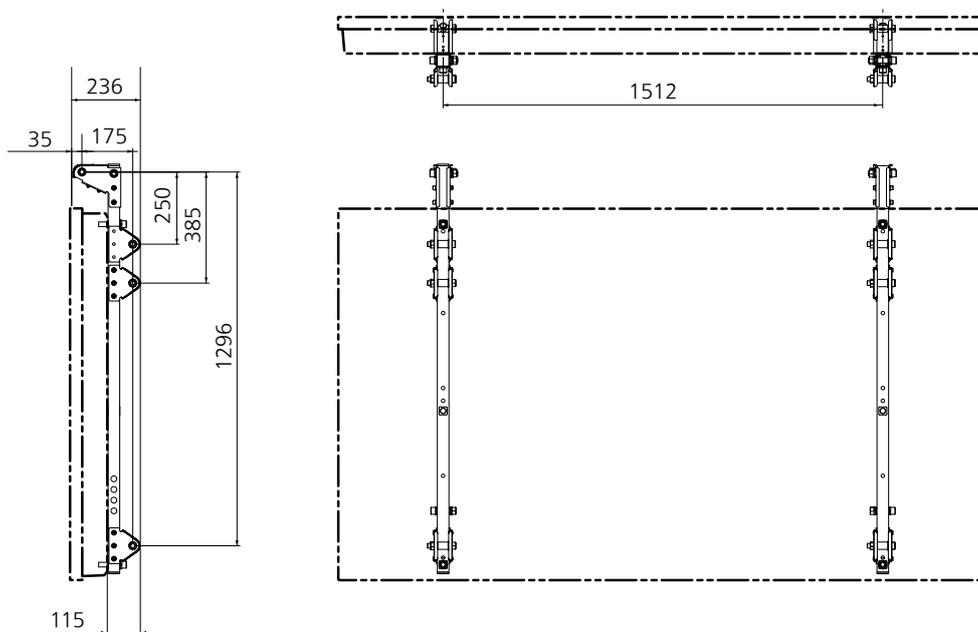
● 外形寸法図 (液晶ディスプレイ TH-98LQ70 取付時) (角度付き吊下げ) : LQ70 / LQ70L シリーズは 0° ~ 10° まで対応)
