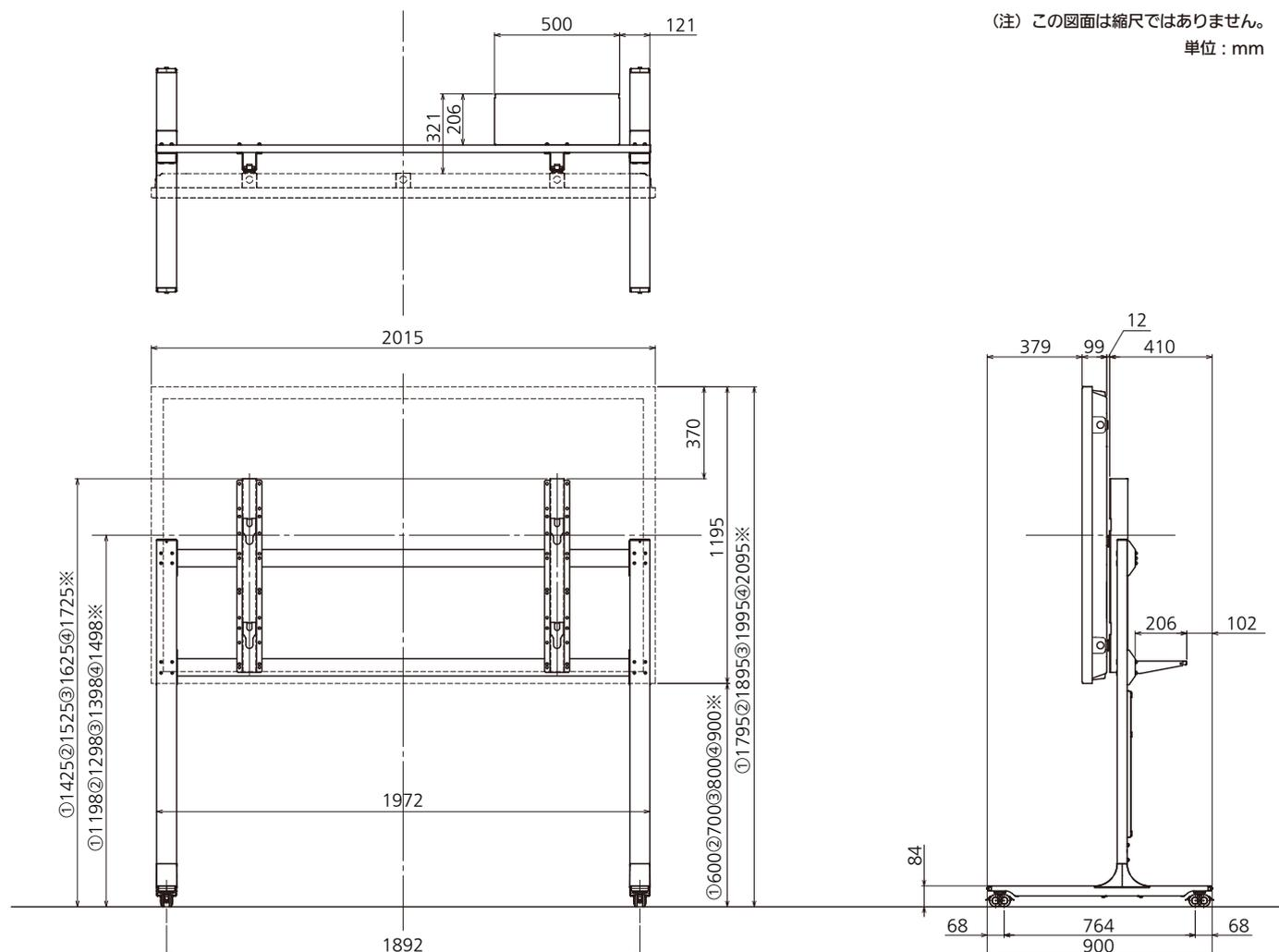
※取り付け金具ねじ穴 刻印 : A→①、B→②、C→③、D→④
