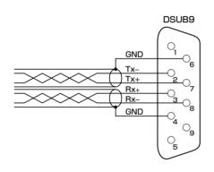
マスター ~ スレーブ間:クロス接続 スレーブ ~ スレーブ間:ストレート接続 推奨ケーブル:2芯シールド (カナレ製A2C3等)
