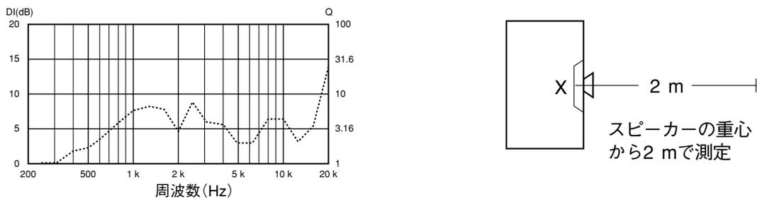
ダイレクティビティファクタ Q : 無指向音源に比べて正面軸上の音の強さが何倍かを表わしています。
