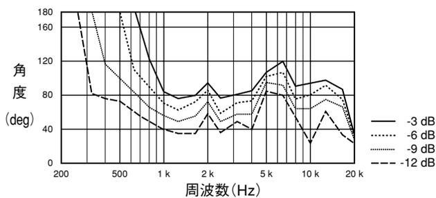
各周波数ごとに上下左右方向で正面軸上に比べて -3 dB、-6 dB、-9 dB、-12 dBになる角度を、プロットしたグラフです。中心軸に対しての片側の角度であり、指向角の半分の値です。
