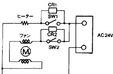
●SW1:ヒーター用サーモスタット 約+6℃でON、約+16℃でOFF
