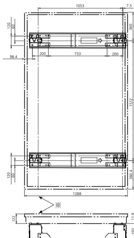
※ 液晶ディスプレイ外形寸法
