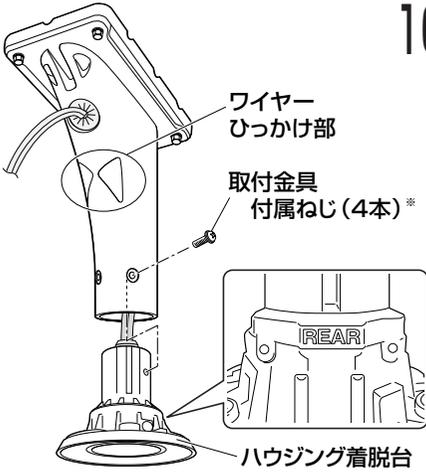
10 ハウジング着脱台を取付金具付属のねじ4本\*で取付金具に取り付けます。ハウジング着脱台の刻印「REAR」がワイヤーひっかけ部側になる向きで取り付けてください。
