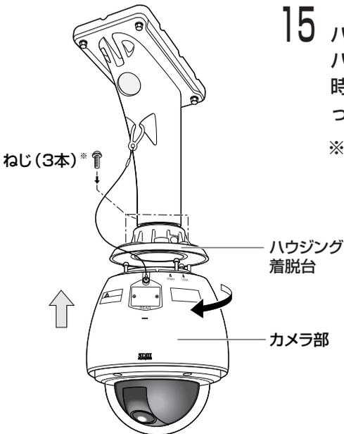
**15** ハウジング着脱台にカメラ部を取り付けます。ハウジング着脱台にカメラ部を取り付け後、カメラ部を時計方向に回します。その後、手順7で外したねじ\*でしっかりと締め付けてください。
