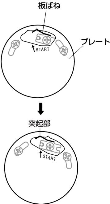
**13** カメラ上部にある板バネの突起部がSTARTの位置にあるか確認してください。STARTの位置にないときは、プレートを時計方向に回し、突起部をSTARTの位置に合わせてください。
