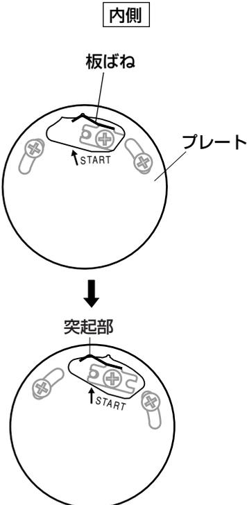
12 カメラ上部にある板バネの突起部がSTARTの位置にあるか確認してください。STARTの位置にないときは、プレートを時計方向に回し、突起部をSTARTの位置に合わせてください。
