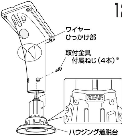
**12** ハウジング着脱台を取付金具付属のねじ4本\*で取付金具に取り付けます。ハウジング着脱台の刻印「REAR」がワイヤーひっかけ部側になる向きで取り付けてください。
