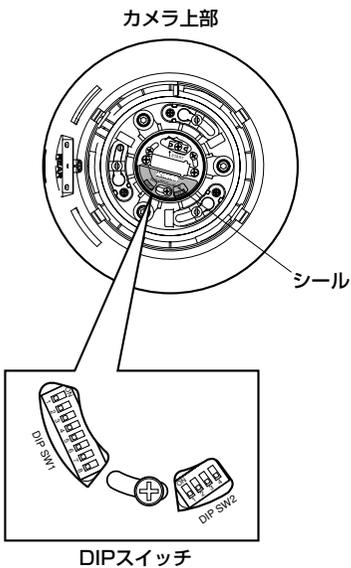
**7** カメラ上部にあるシールをはがし、DIPスイッチで通信方式とユニットアドレスを設定します。DIPスイッチの設定のしかたはカラーテレビカメラ（WV-CW960）の取扱説明書をお読みください。設定したら、シールを元の位置に貼り直します。
