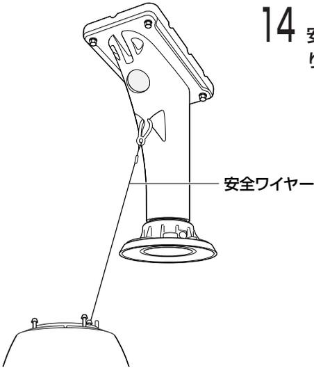
**14** 安全ワイヤー（カメラ付属）を図のように、カメラ天井吊り下げ金具に取り付けます。
