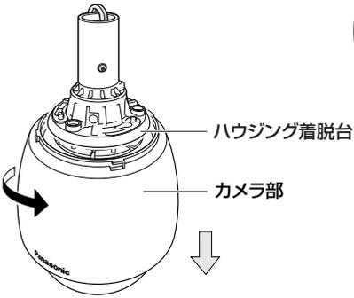
**6** カメラ部を反時計方向に回して、ハウジング着脱台と分離します。
