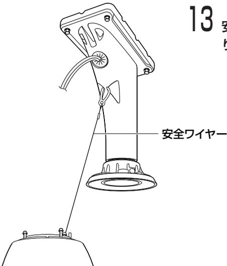
**13** 安全ワイヤー（カメラ付属）を図のように、カメラ天井吊り下げ金具に取り付けます。
