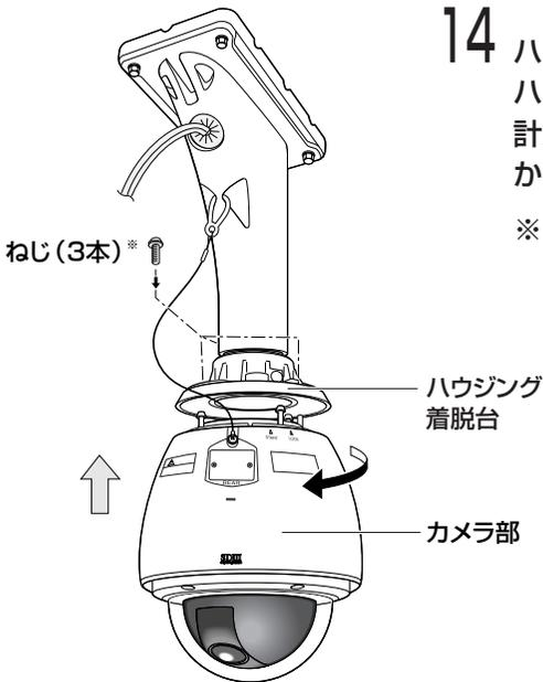
**14** ハウジング着脱台にカメラ部を取り付けます。
