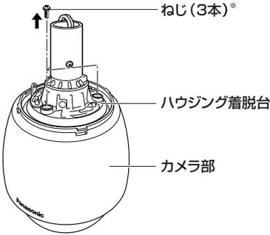
**5** カメラ本体のハウジング着脱台とカメラ部を固定しているねじ3本\*を外します。取り外したねじ\*は取り付け時に必要です。紛失しないよう注意してください。
