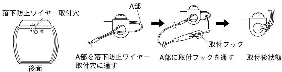
②カメラ上面に、ワイヤー取付金具を取り付けます（カメラに付属の説明書をお読みください）。
