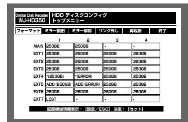
<デジタルディスクレコーダーの ディスクコンフィグメニュー（SINGLE）>
