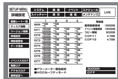
<デジタルディスクレコーダーのSETUP MENUディスク情報画面>
