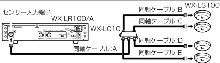
**【良い例1】** 同軸ケーブル長が、A=40 m、B=8 m、C=4 m、D=6 m、E=10 mの場合
