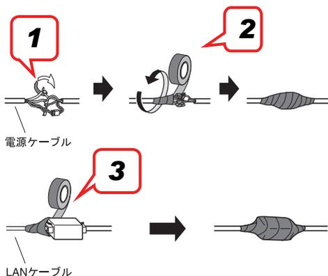
**1** 電源ケーブル、アラーム入出力ケーブルを接続します。
