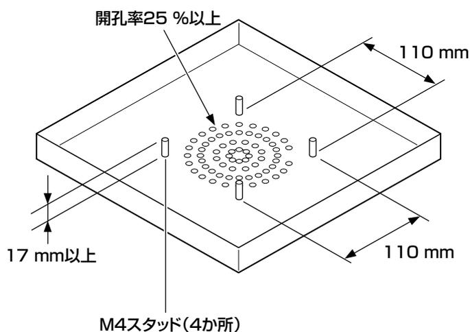
②ナット（現地調達ステンレス製）で、設備プレートに本機を取り付けます。
