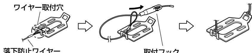
①落下防止ワイヤーの輪の部分をワイヤー取付穴に通します。
