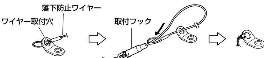
①落下防止ワイヤーの輪の部分をワイヤー取付穴に通します。
