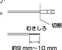
※外皮を切断したしん線が外部I/O用端子から露出せず、確実に接続されていることを確認してください。
