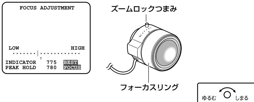
1. ズームロックつまみをゆるめ、ズームとフォーカスリングで被写体に応じて画角（視野角）を調節します。
