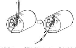
透明チューブ側の輪をワイヤー取付穴に通 し、ワイヤー取付フックを輪の中に通しま
