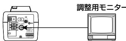
調整用モニターがあるときは、後面のモニター出力端子に接続します（設置工事時のみ）。
