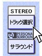
[トラック選択] ボタンをクリックするたびに、再生トラックがSTEREO L R MONOの順に切り換わります。
