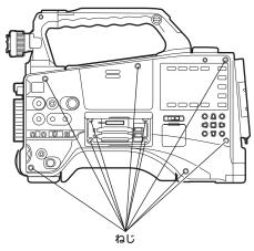
3 下図のようにサイドRパネルを取り外します。取り外しの際は、本体とパネル間の FFCおよびコネクターに負荷がかからない ようにお気をつけください。
