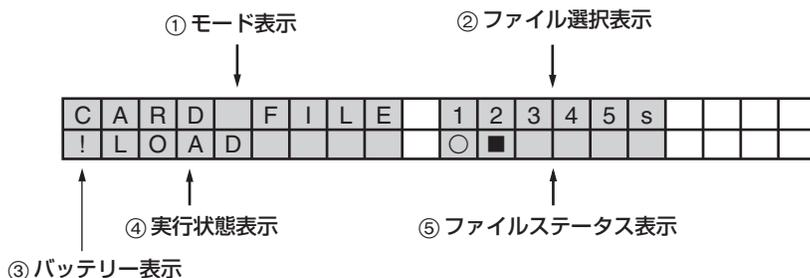
①モード表示 : 本機がIC CARDモードで動作していることを表します。
