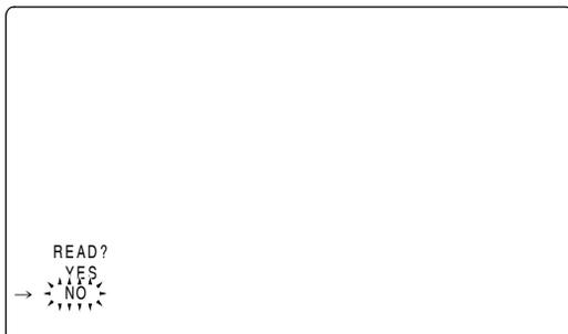
6 JOGダイヤルボタンを回して矢印（カーソル）をYESに移動し、JOGダイヤルボタンを押します。データの読み出しが終了すると、次のようなメッセージが表示されます。
