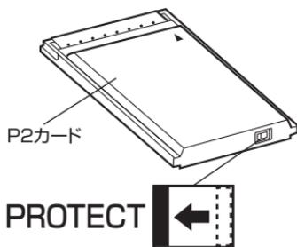
メモリーカードアダプター (AJ-P2AD1) をお使いの場合、書き込みや消去を防止するには、アダプターに装着したメモリーカードの書き込み禁止スイッチを切り替えてください。
