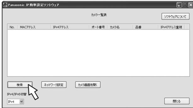
3 設定するカメラのMACアドレス / IPv4 アドレスをクリックし、[ネットワーク設定] ボタンをクリックします。
