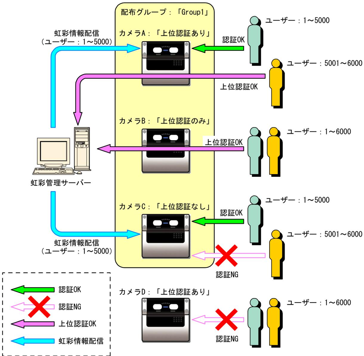
配布グループ「Group1」に登録されているカメラのうち、カメラAとCには、ユーザーIDの上位5000人分（ユーザー1~5000）の虹彩情報が配信されます。カメラBは「上位認証のみ」に設定されているため、誰が認証を行っても必ず上位認証により認証を行います。虹彩情報は配信されません。カメラDは「Group1」に属していないので、ユーザー1~6000は認証を行えません。カメラAで虹彩情報の配信された5000人は、カメラによって認証を行うことができます。虹彩情報の配信されていない残りのユーザー（ユーザー5001~6000）は、ユーザーの認証方法が「有効（カメラで認証）」、「有効（上位認証のみ）」どちらの設定でも必ず上位認証により認証が行われます。カメラCは「上位認証なし」の設定になっているため、虹彩情報の配信されたユーザー（ユーザー1~5000）だけが認証を行うことができます。カメラの設定に関係なく、ユーザーの認証方法で「無効」を選択した場合、カメラで認証を受けることができません。
