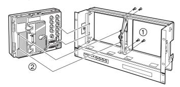
**5** 背面の板を固定し、モニターに操作部のコードを差し込みます。
